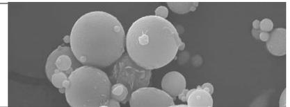
Die Flugasche **POWERMENT®** ist ein feinkörniger, hauptsächlich aus staubartigen, glasigen Partikeln bestehender Baustoff, der bei der Strom- und Wärmeerzeugung aus Steinkohle im **HKW 2** als Nebenprodukt anfällt. Hauptbestandteile der Flugasche sind die aus den natürlichen Kohlebegleitmineralien entstehenden amorphen Phasen von Silizium-, Aluminium- und Eisenoxid.
