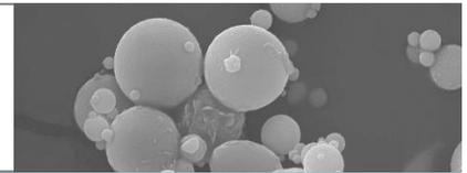
Die Flugasche **POWERMENT®** ist ein feinkörniger, hauptsächlich aus staubartigen, glasigen Partikeln bestehender Baustoff, der bei der Strom- und Wärmeerzeugung aus Steinkohle im **Kraftwerk Bexbach** als Nebenprodukt anfällt. Hauptbestandteile der Flugasche sind die aus den natürlichen Kohlebegleitmineralien entstehenden amorphen Phasen von Silizium-, Aluminium- und Eisenoxid.
