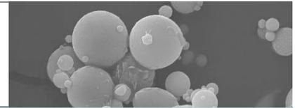
Die Flugasche **POWERMENT®** ist ein feinkörniger, hauptsächlich aus staubartigen, glasigen Partikeln bestehender Baustoff, der bei der Strom- und Wärmeerzeugung aus Steinkohle im **GKM Block 9** als Nebenprodukt anfällt. Hauptbestandteile der Flugasche sind die aus den natürlichen Kohlebegleitmineralien entstehenden amorphen Phasen von Silizium-, Aluminium- und Eisenoxid.
